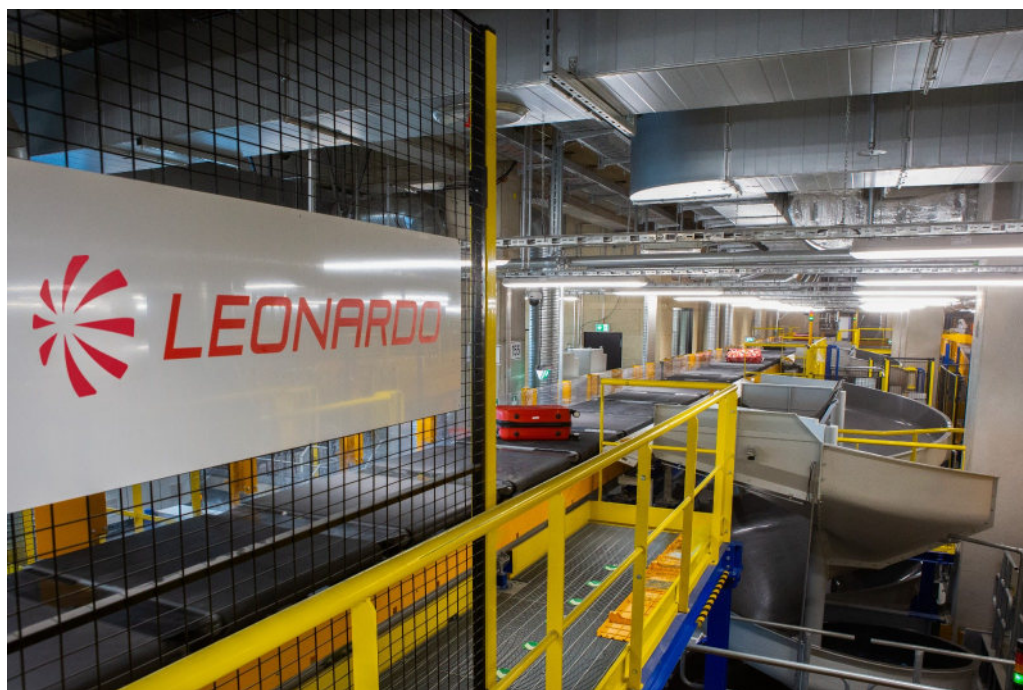
Il sistema Mbhs messo a punto da Leonardo per lo smistamento bagagli
